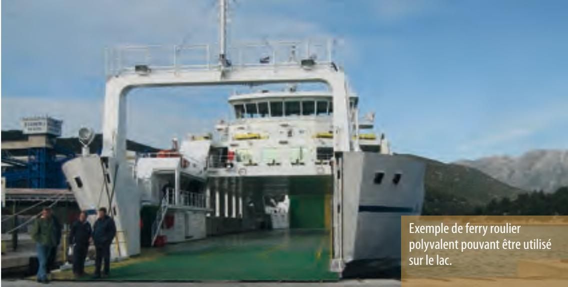
Exemple de ferry roulier polyvalent pouvant être utilisé sur le lac.
